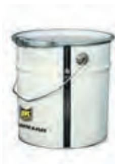
Акриловая краска на водной основе, без запаха, легко наносится и быстро сохнет, не загрязняет окружающую среду и не выцветает. Используется для покрытия изоляции как внутри помещения, так и снаружи. Выпускается объемом 2,5 л. Расход краски 0,45-0,5 л/м<sup>2</sup> в два слоя. Транспортиро-
